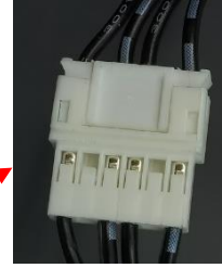
Conexión giratoria al motor del eje Y
