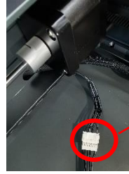
Conexión giratoria al motor del eje Y
